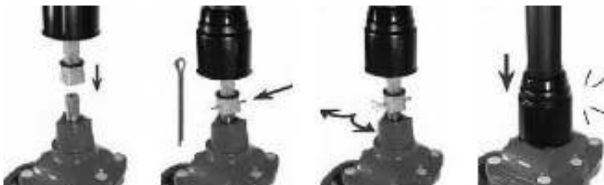
Рис. 4 Порядок установки телескопического штока на задвижку.
